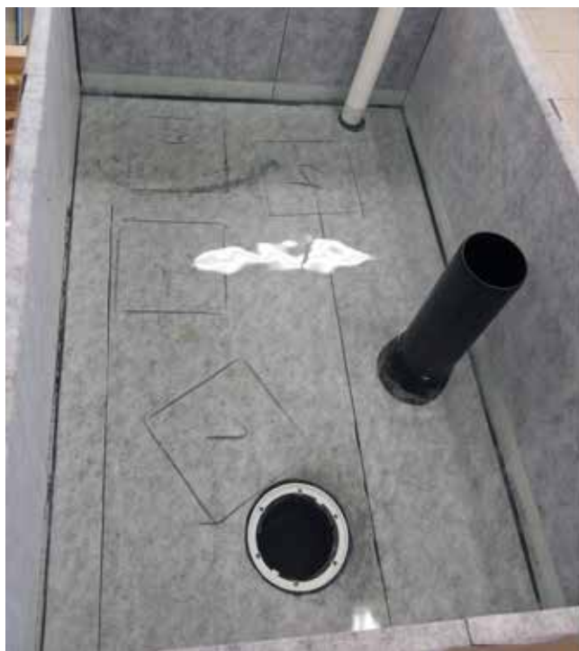
Bildet viser eksempel på foliemembran som prøves for vanntetthet mot sluk og rørgjennomføringer. Prøvingskassen er fylt med 100 mm vann. Ill.: SINTEF
